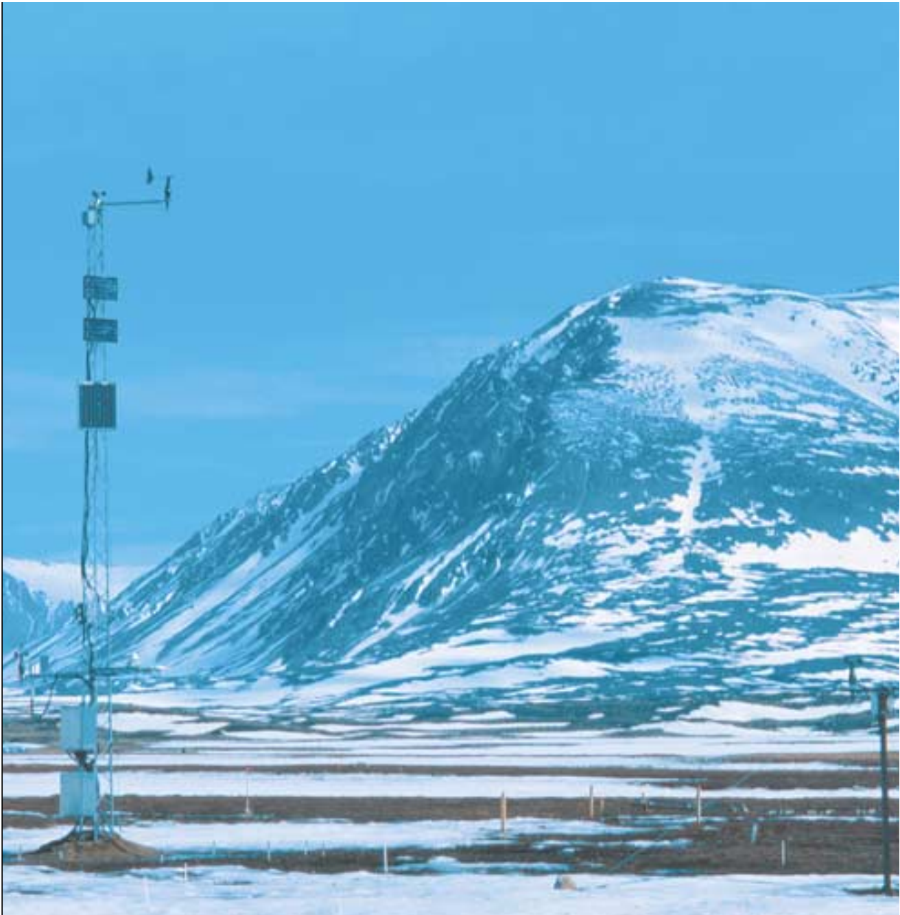
"Hjertet" i natur- og miljøovervågningen i Zackenberg er en avanceret automatisk klimastation som året rundt registrerer en lang række vejrparametre samt ind- og udstråling, snetykkelse, temperaturer i jorden m.v.
