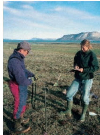
Fig. 19. Jordluft fra forskellige dybder pumpes op til overfladen og analyseres for bl.a. luftens indhold af ilt og kuldioxid. Foto: Bo Elberling.
