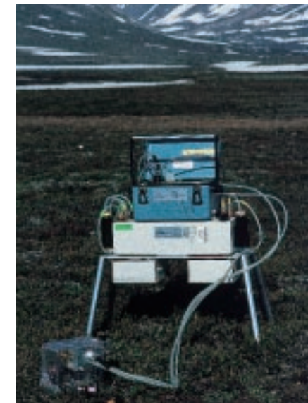
Fig. 20. Forholdet mellem hvor meget kuldioxid, der henholdsvis frigives og optages i jorden, måles som en ændring \text{CO}_2 -koncentrationen i et kammer. Foto: Bo Elberling.
